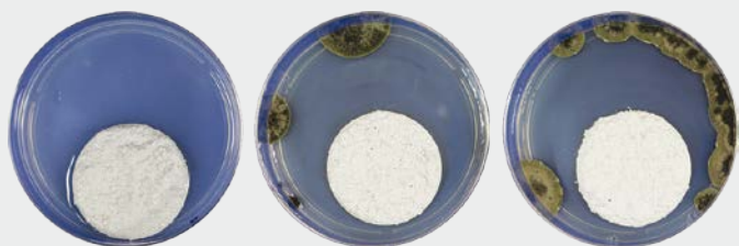
Rast plesní na omietke PCI Multiputz® NoBio Z
