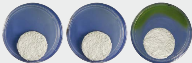
Rast plesní na omietke PCI Multiputz® NoBio Z
